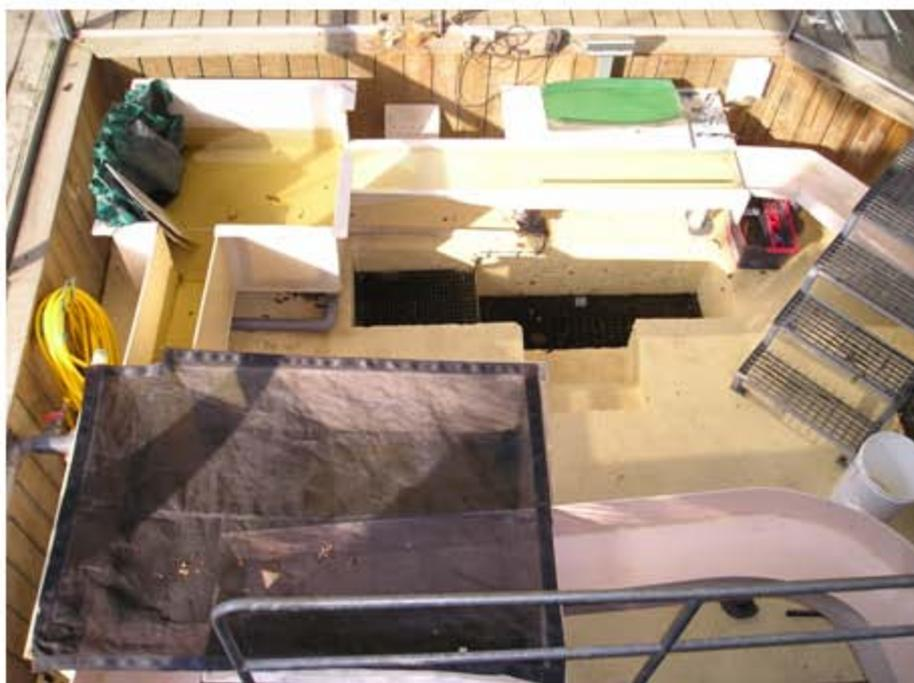
La chaîne de manipulation du Moulin des Princes. L'ensemble a été conçu pour que le poisson reste au maximum dans l'eau afin de limiter le stress
